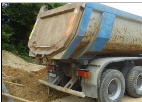
Obr. 7 Řešení Volvo: příčník z trubky; polohování pomocí čepů; ramena - uzavřený profil s odlehčením
