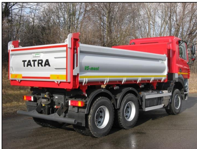
Obr. 8 Řešení Tatra: příčník z trubky; ramena - plechový výpalek; aretace pomocí čepů
