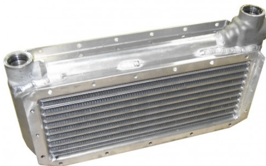
Obr. 1.2: Olejový chladič Beech King Air 100 Wood (2011)
