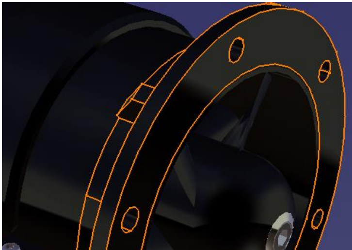
Obr. 23 - Detail 3D modelu příruby nasunuté na statoru dmychadla - CATIA
