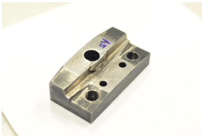
Obr. 5-6 Odlovení části střížnice a její následné přivaření, malá tloušťka materiálu střížnice
