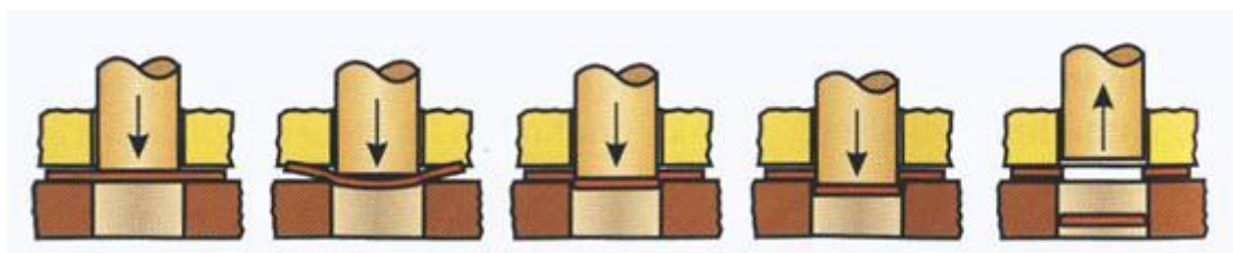
Obr. 2-2 Princip stříhání pomocí stříhadla [7]
