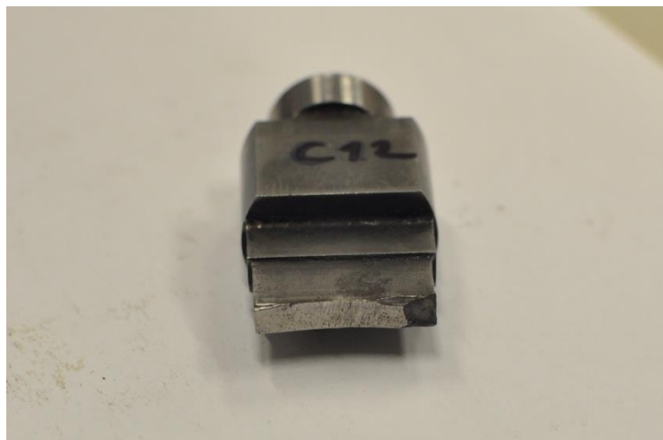
Obr. 5-10 Nadměrné opotřebení, vylomení části nástroje v oblasti střižné hrany
