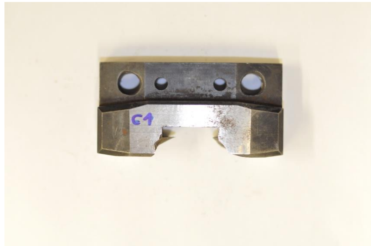
Obr. 5-8 Celkové roztržení střížnice
