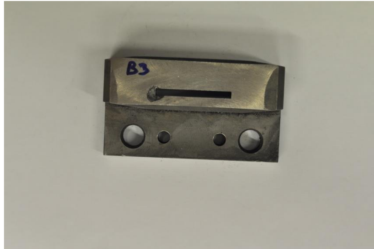
Obr. 5-7 Vylomení části střížné hrany
