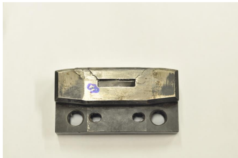
Obr. 5-9 Rozlomení a zpětné navaření části střížnice, ulpívání materiálu
