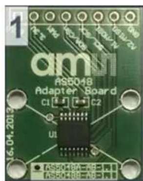
Obrázek 2.24: Senzor AS5048A (vlevo) [27] a neodymový magnet [26]
