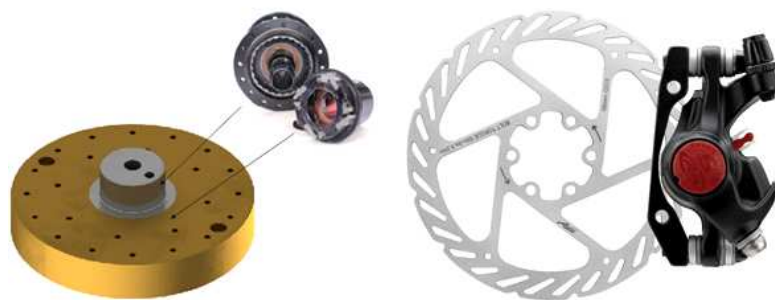
Obrázek 2.7: Prvotní model držáku vzorků inspirovaný nábojem kola (vlevo) a kotoučová brzda (vpravo)
