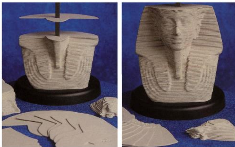
Obr. 5-1 Princip vrstvení tělesa [29]
