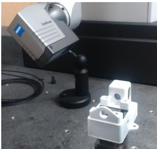
Obr. 3-16 Měření na mostovém SMS
