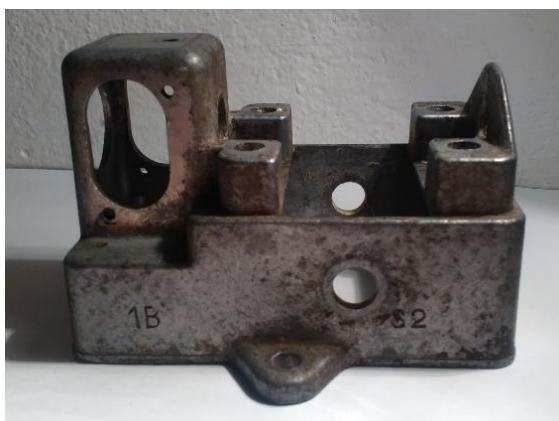
Obr. 2-5 Odstrojené těleso přepínače
