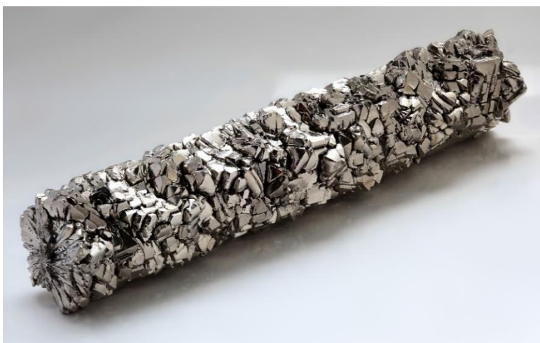
Obr. 10 Titanová krystalová tyč o 99,995 % čistotě [20]
