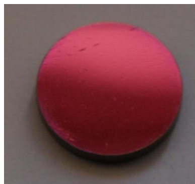
Obr. 26 Zbarvení slitiny Ti35Nb2Zr
