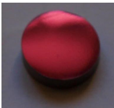
Obr. 25 Zbarvení slitiny Ti25Nb4Ta8Sn
