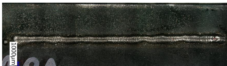
Obrázek 19 - Impulzní přenos 20 A (vlastní zdroj)
