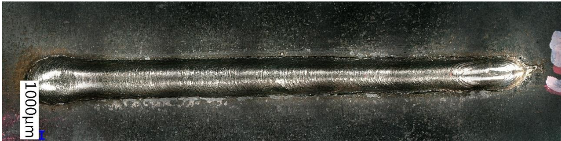
Obrázek 23 - Impulzní přenos 60 A (vlastní zdroj)
