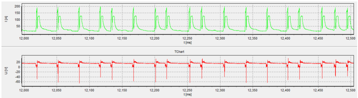
Obrázek 32 - Průběh proudu a napětí IAC přenosu při 40 A (vlastní zdroj)
