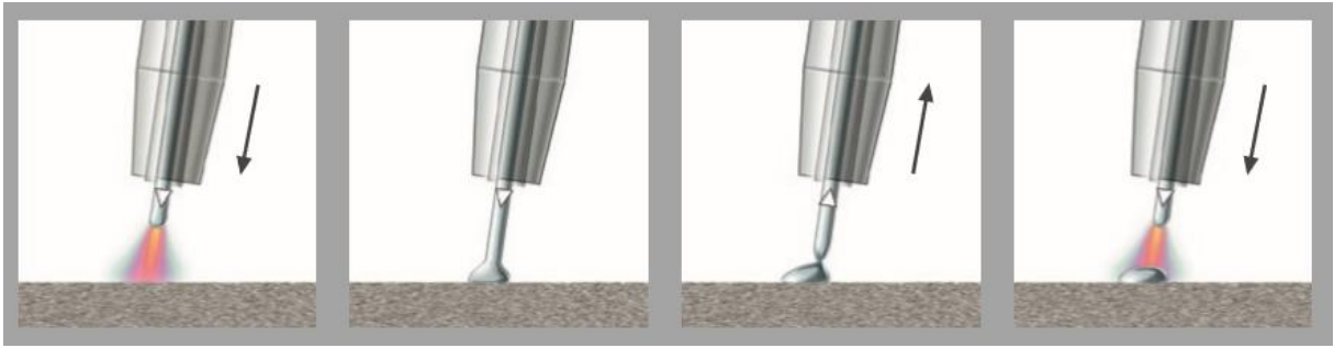
Obrázek 14 – Průběh fází procesu CMT [29]
