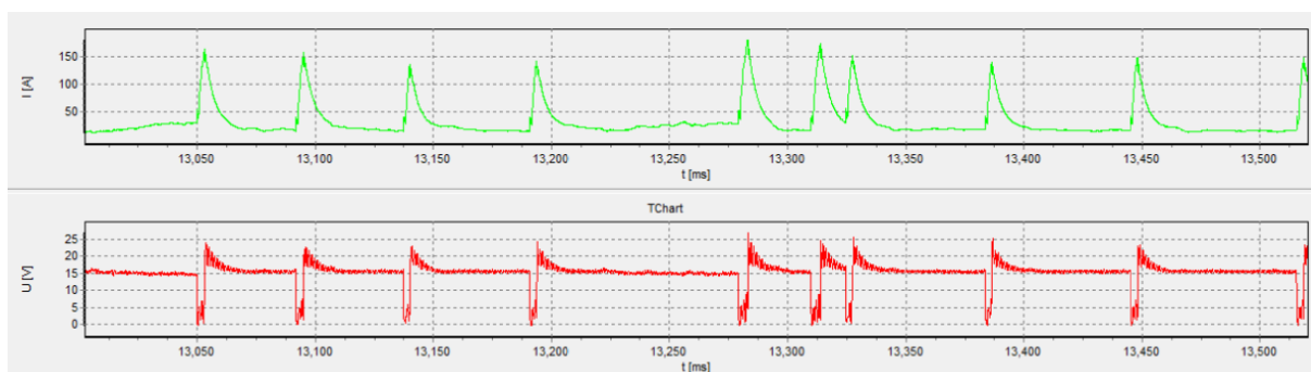
Obrázek 26 - Průběh proudu a napětí zkratového přenosu při 40 A (vlastní zdroj)
