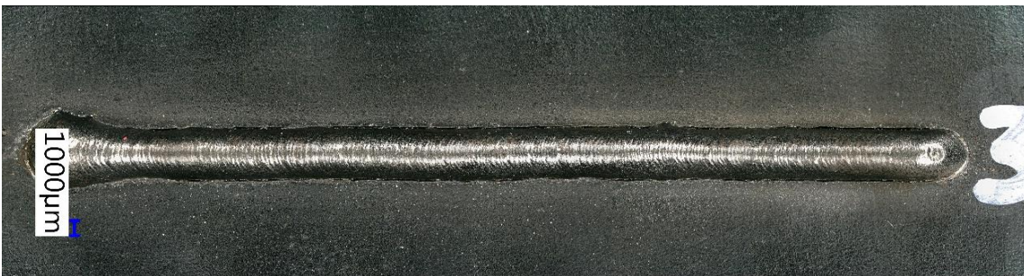
Obrázek 24 - Zkratový přenos 60 A (vlastní zdroj)
