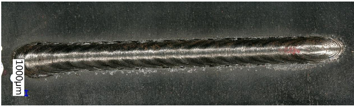
Obrázek 22 - Impulzní přenos 60 A DUOplus (vlastní zdroj)
