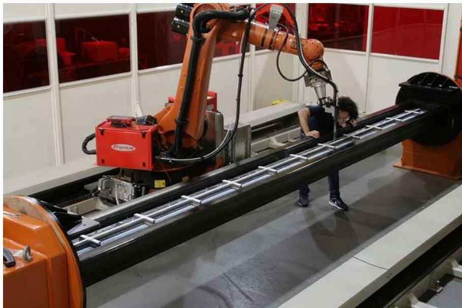
Obrázek 4 - Příklad pracoviště WAAM [10]
