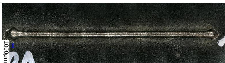
Obrázek 18 - Zkratový přenos 40 A (vlastní zdroj)
