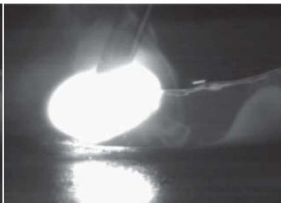
Obrázek 12 - Okamžik opětovného zapálení oblouku [17]
