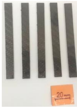
Obr. 14 Ohybová tělesa před vykonáním zkoušky
