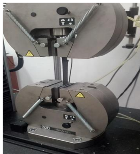
Obr. 16 Čelisti trhacího zařízení svírající zkušební vzorek
