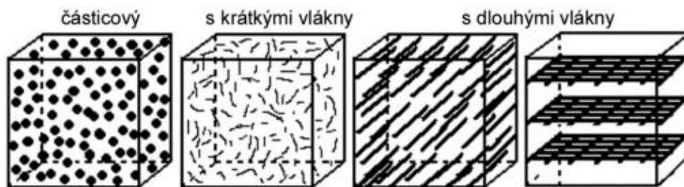
Obr. 1 Dělení kompozitních materiálů podle tvaru a uspořádání výztuže [4].
