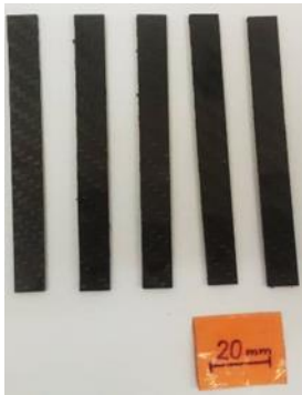
Obr. 14 Ohybová tělesa před vykonáním zkoušky
