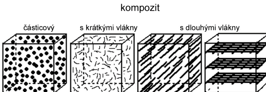
Obr. 2 Rozdelenie kompozitov podľa geometrie výstuže [16]
