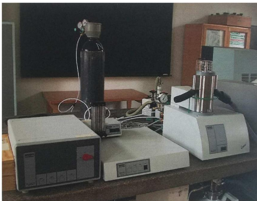
Obr. 18 Prístroj pre termickú analýzu NETZSCH STA 409 PC LUXX [47]
