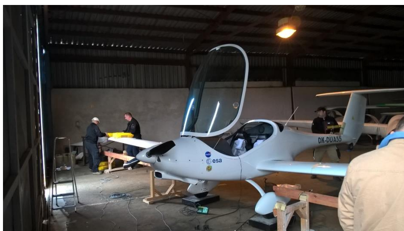
Obrázek 25: Umísťování závaží na křídlo letounu
