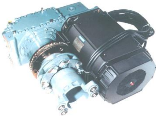
Obr. 13 - Příčný pohon pomocí dutého hřídele a ojníčkové spojky [2]
