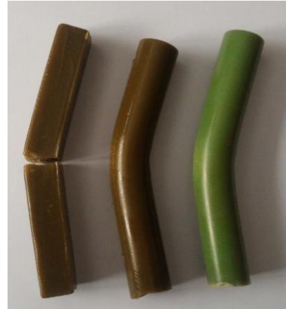
Obr. 20. Vzorčky pro provedení zkoušky ohybem [28]
