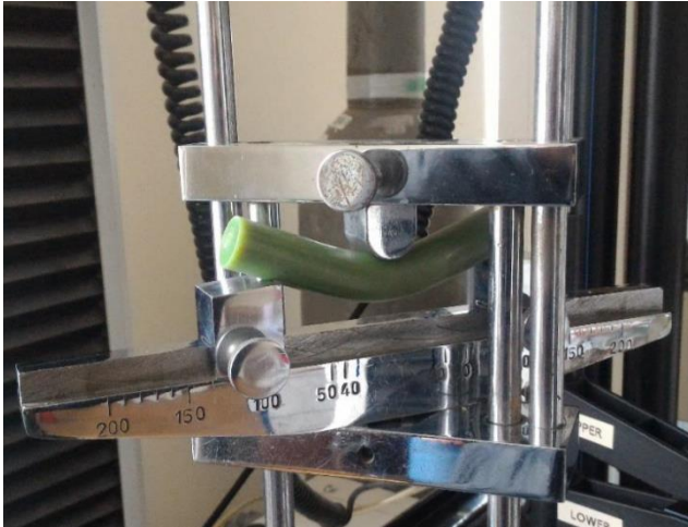
Obr. 19. Stanovení modulu pružnosti pro voskový model [28]
