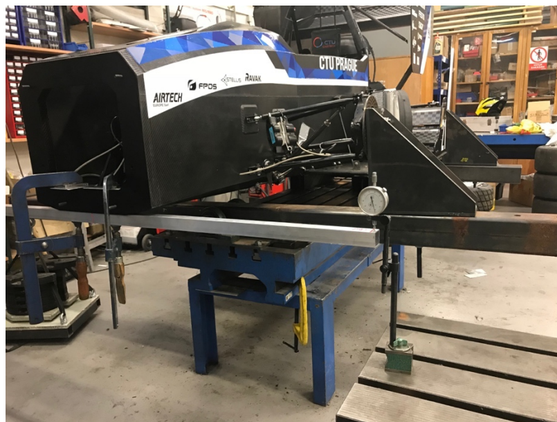
Obr. 33-Příklad odečítání hodnot v přední části vozu
