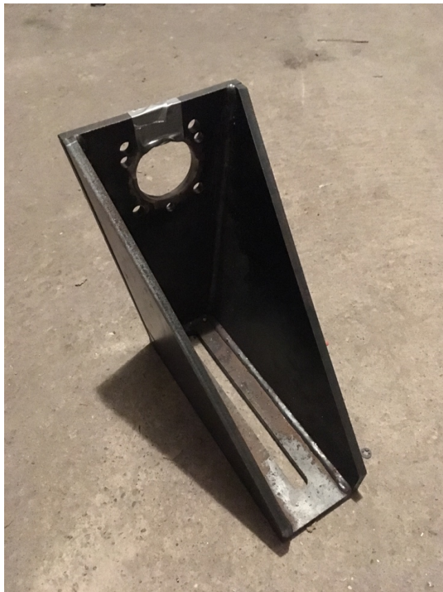
Obr. 22- Část přípravku pro měření torzní tuhosti
