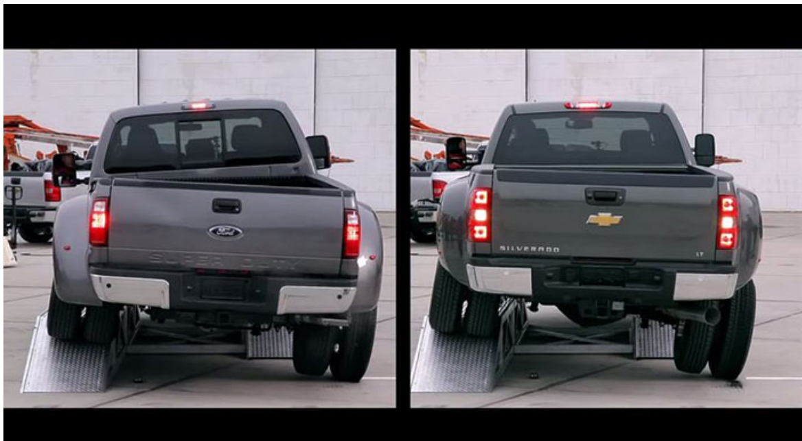
Obr. 8-Demonstrace rozdílné torzní tuhosti [5]
