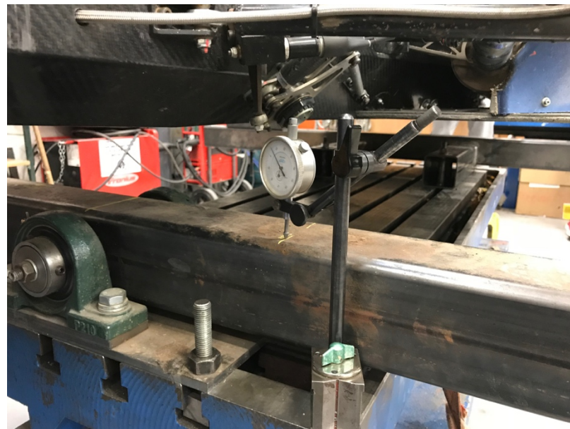
Obr. 31-Úchylkoměr na přední části přípravku
