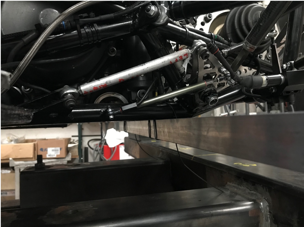
Obr. 10-Ukázka náhrady pružiny pevnou vzpěrou na vozu FS.10
