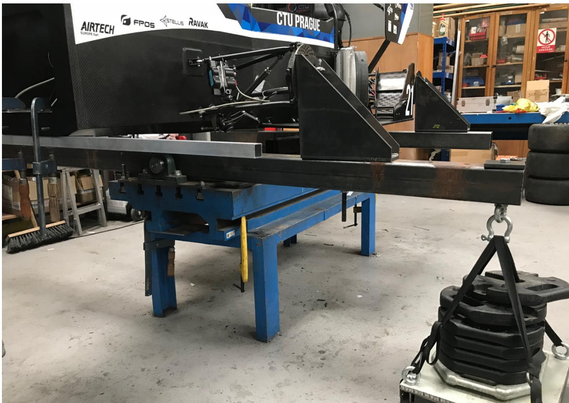
Obr. 29-Ukázka zatížení při experimentu
