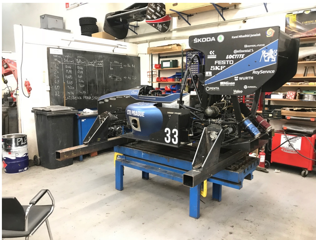
Obr. 28-Vůz FS.09 uchycen ven zkušebním přípravku
