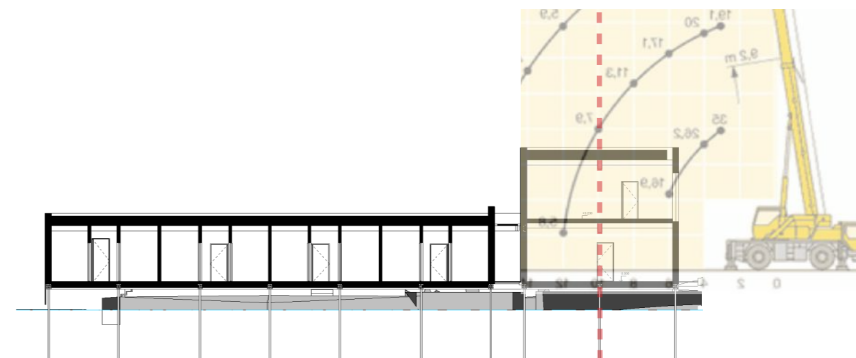
Schématický rez uloženia lepených drevených nosníkov s dosahom žeriavu.
