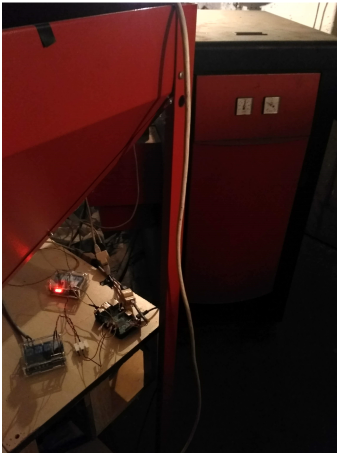
Obrázek 10.2: Zapojení centrálního regulátoru (Raspberry Pi), relé modulů (k nim zapojené koncová zařízení) a 1-Wire sběrnice v kotelně.
