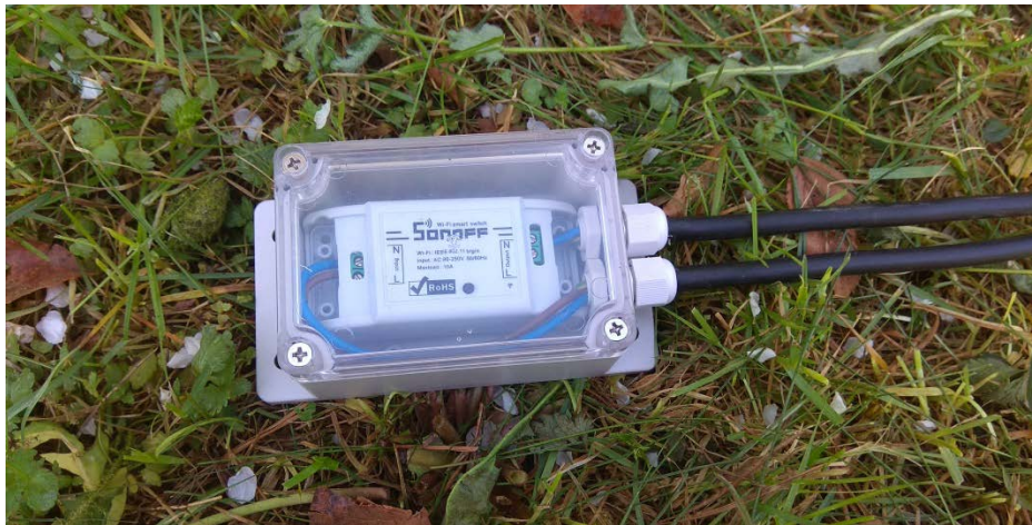
Obr.8: Ověření vodotěsnosti ochranné krabice Zdroj: vlastní foto
