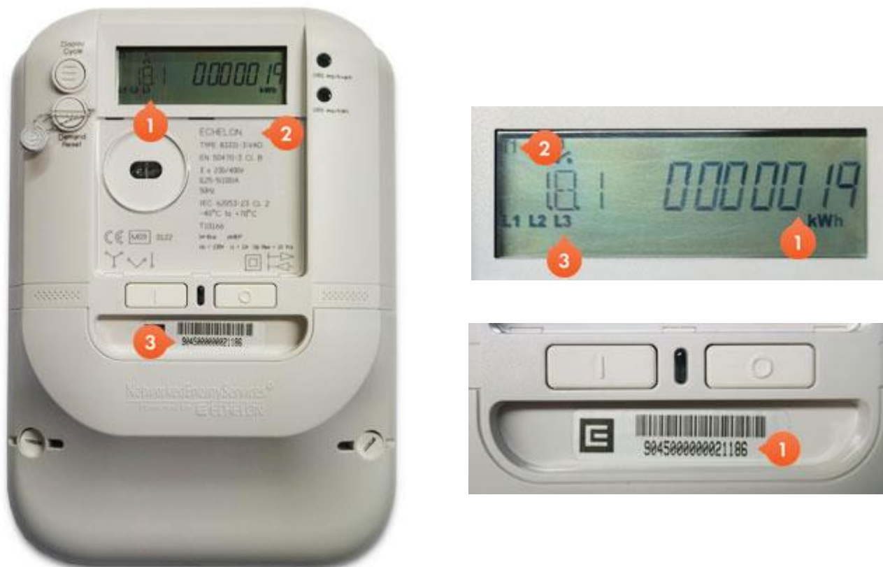
Obr. 2.2.2: Vzhled moderního elektroměru ECHELON 8331-3 [10]
