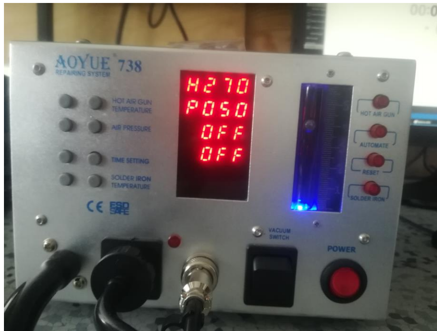
Obr. 5.4 Nastavené parametry pro horkovzdušnou pistoli. Zdroj: autor.
