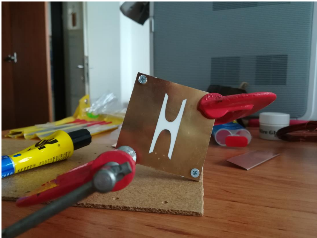
Obr. 5.2 Fixace slepených substrátů. Zdroj: autor.
