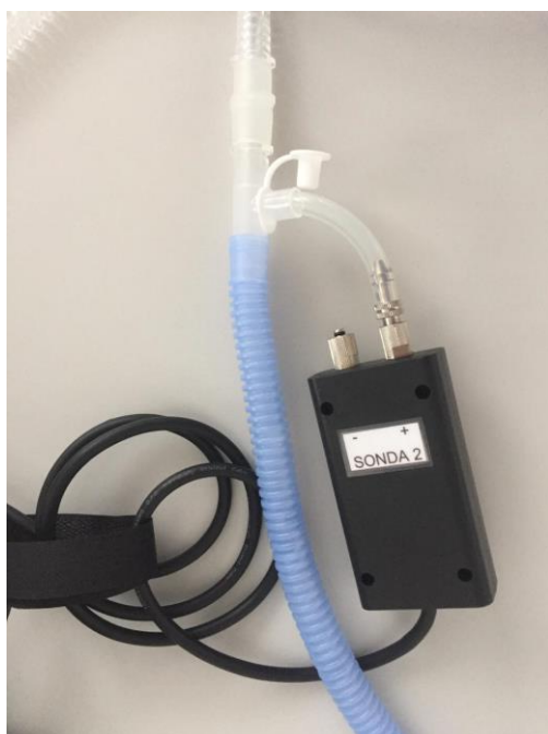
Obrázek 3.3 Umístění sondy 2 v místě za zvlhčovací komorou
