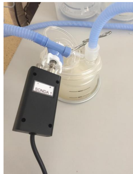
Obrázek 3.2 Umístění sondy 1 v místě zvlhčovací komory
