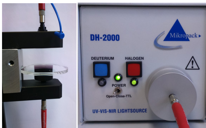
Obrázek 27: Konstrukce spektrometru (vlevo: konstrukce s měřenou čočkou a optickými vlákny, vpravo: světelný zdroj)
