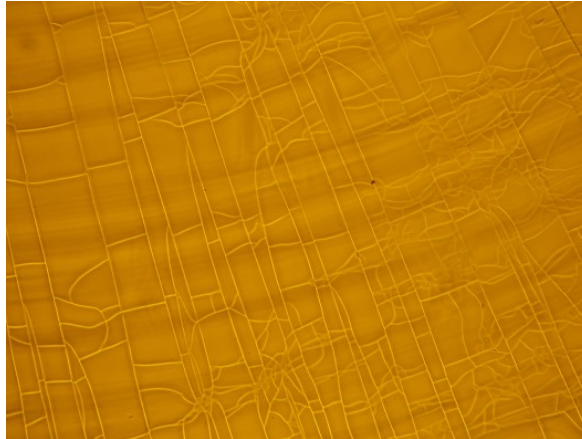
Obrázek 30: Popraskaná povrchová úprava na brýlové čočce „Omega Max“. (zvětšení 10x)
