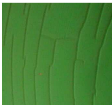
Obrázek 24: Popraskání antireflexní vrstvy vlivem přehřátí [29]
