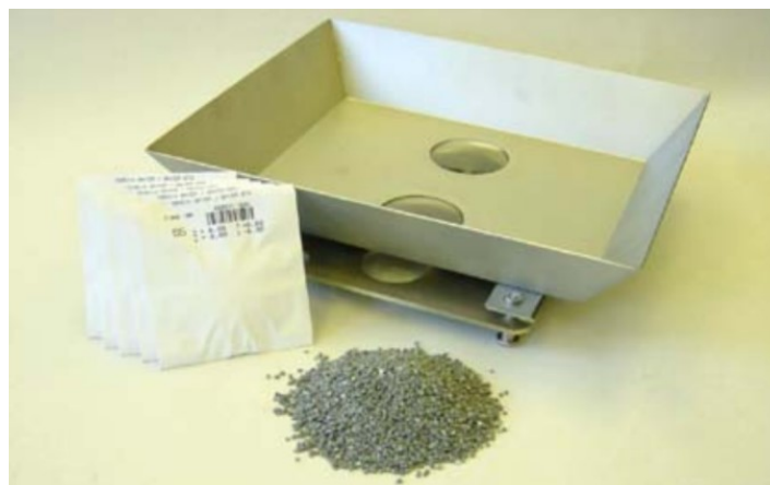
Obrázek 21: Testování čočky přicházející do kontaktu s abrazivní složkou [24]
