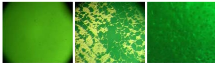
Obrázek 25: Výsledky varného testu (vlevo: čočka bez poškození, prostřední: nadměrné popraskání, vpravo: efekt "pomerančové kůry") [24]
