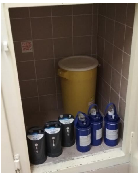
Obrázek 10 Uskladnění již nepoužitelných radionuklidových generátorů ve stíněném trezoru v centrální vymírací místnosti
