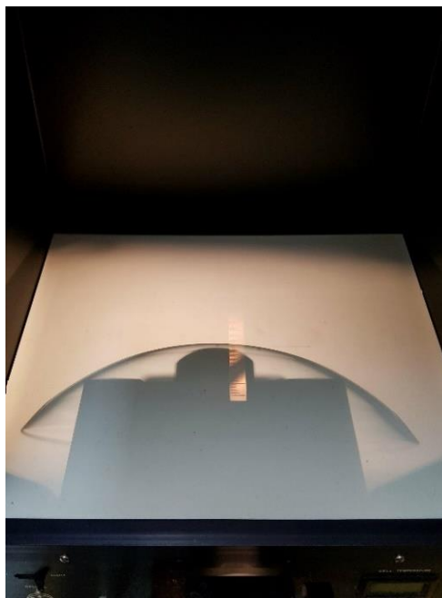
Obr. 5.2: Měření zakřivení kontaktní čočky [vlastní fotoarchiv]
