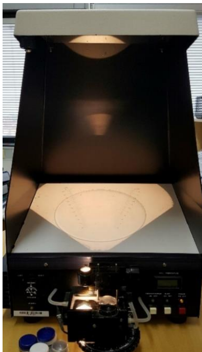
Obr. 5.1: Optimec měřící průměr čočky. [vlastní fotoarchiv]
