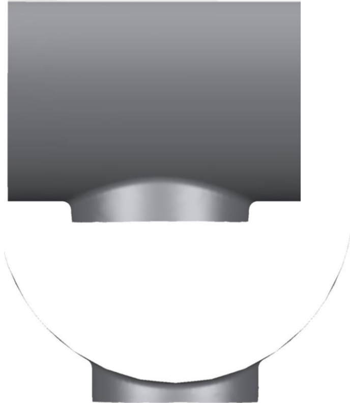
Obrázek 12: optimální tvar při simulaci vyhrdlení
