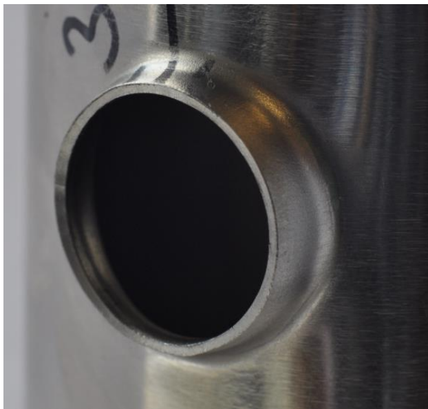
Obrázek 13: pohled na vyhrdlení optimálního prostříhu s poloosami 8x6mm
