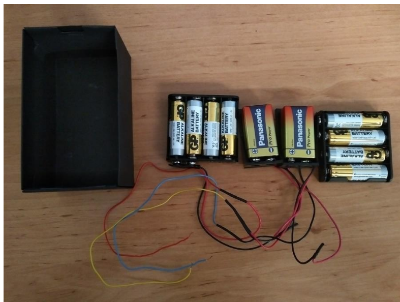
obr.č. 7 – Sestavené napájení
