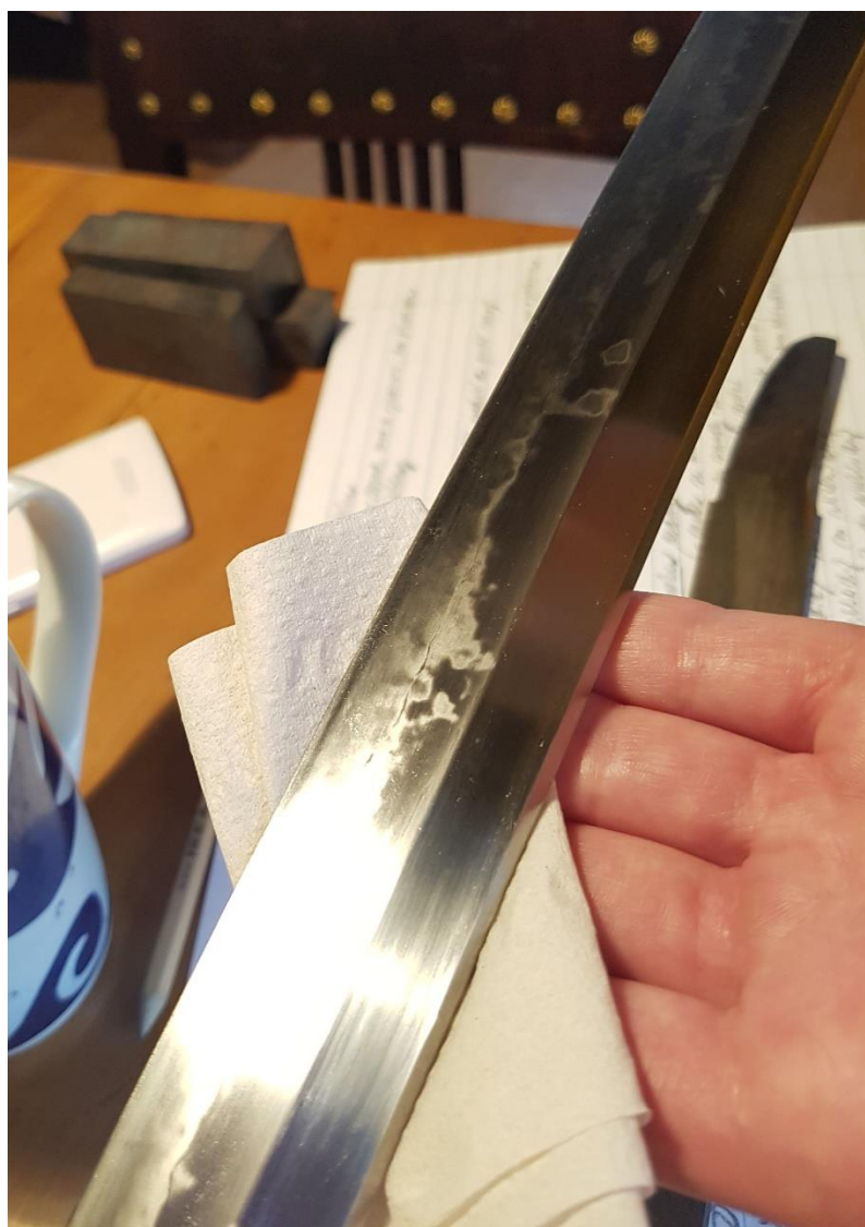
Obrázek 32 Vyniknutí linie hamon po kalení a vyleštění čepel
