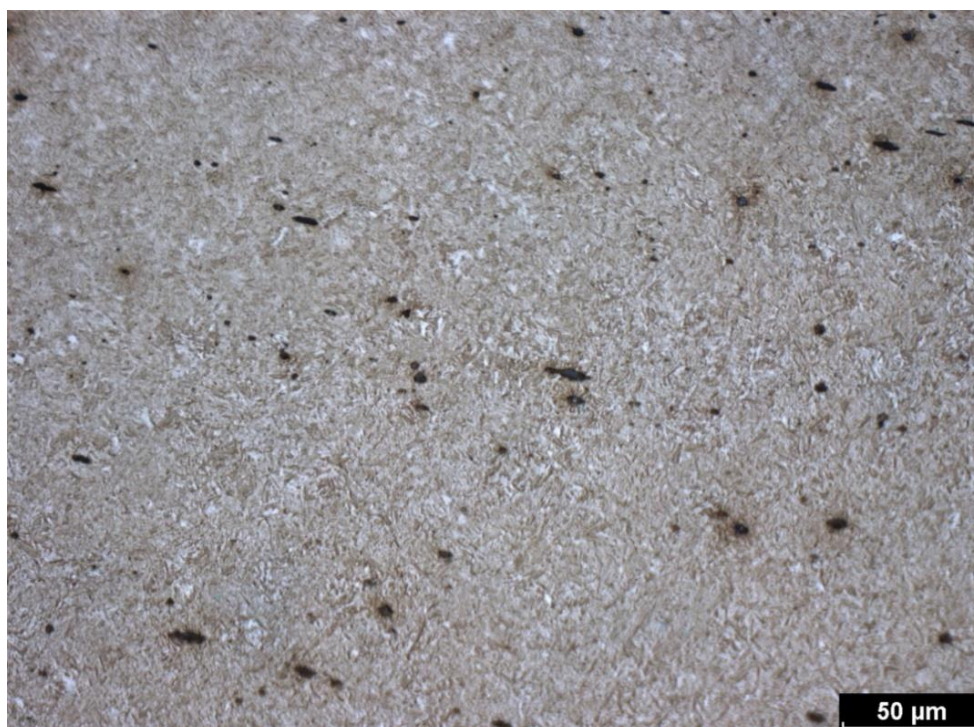
Obrázek 52 Martenzit na ostří břitu meče
