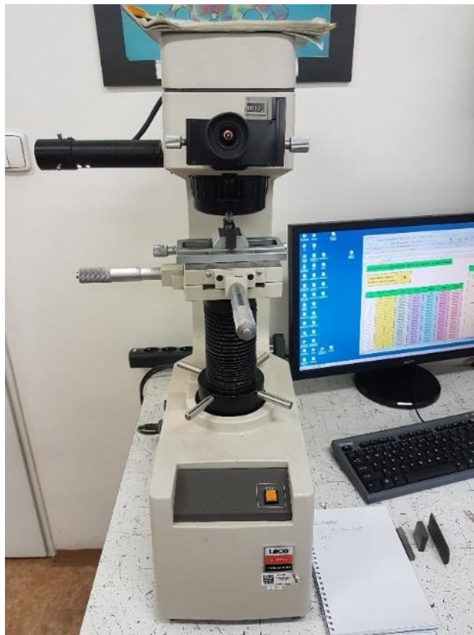
Obrázek 23 Tvrdoměr LECO V-100-C
