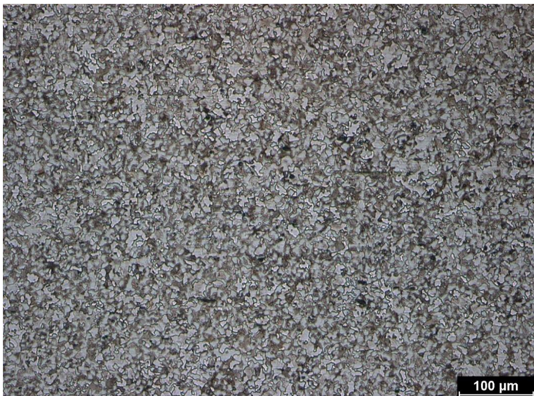
Obrázek 40 Perliticko-feritická jemnozrná struktura, oblast pozorování tvrdý břit
