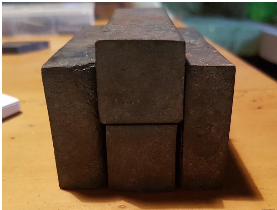
Obrázek 26 Konstrukce Hon-san-mai-awase-gitae skládající se z měkkého jádra (horní kus), tvrdého pláště (boční kusy) a tvrdého ostří (spodní kus)
