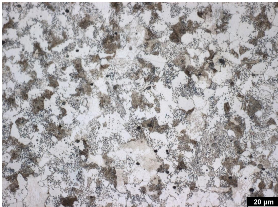
Obrázek 51 Vyobrazení struktury perliticko-feritické s globulárním perlitem
