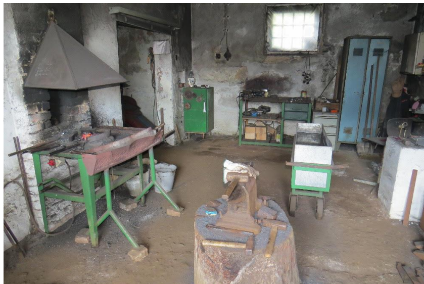
Obrázek 29 Kovárna Dachsových pohled na zařízení, kovadlinu, výheň, kalící nádobu
