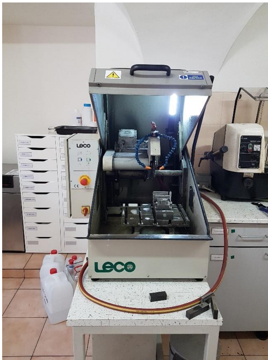
Obrázek 15 Metalografická rozbrušovací pila LECO
