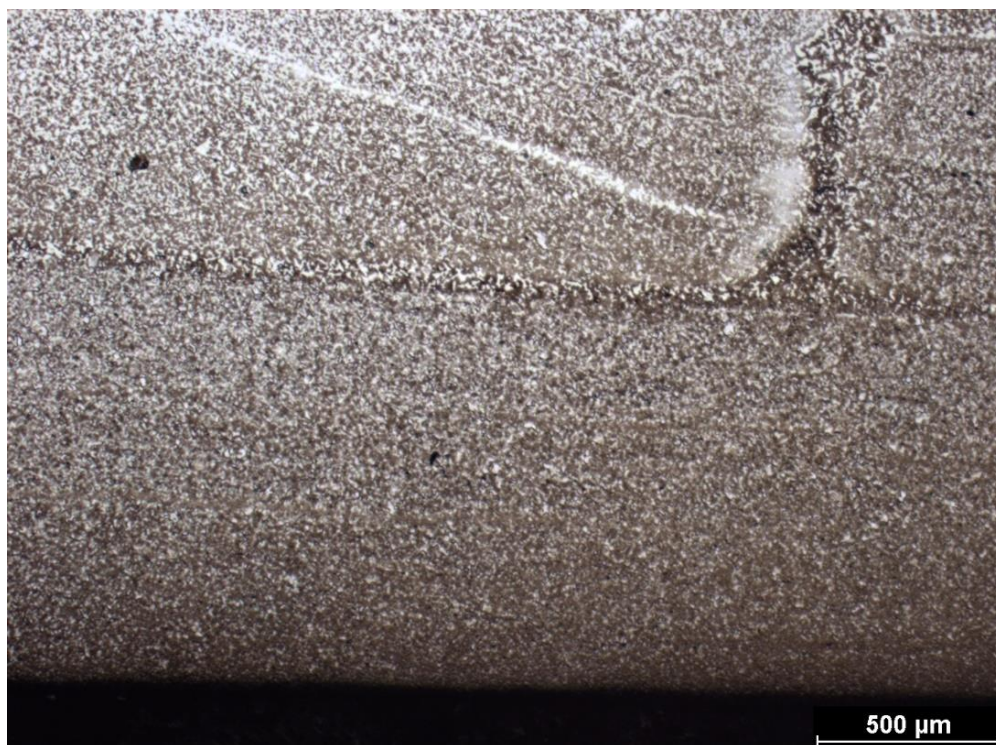
Obrázek 49 Vyobrazení přechodové oblasti z měkké na tvrdou část
