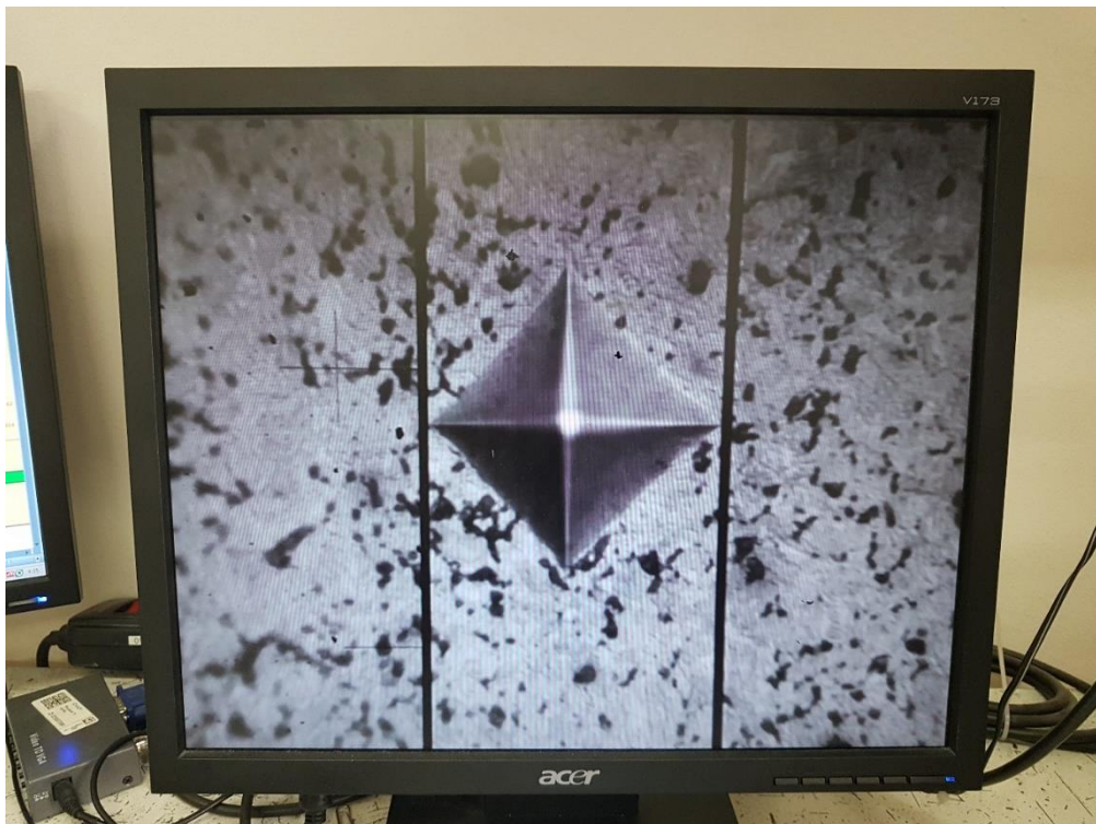
Obrázek 55 Zobrazení na monitoru, detail vpichu do vzorku po zatížení 10 N (1 kg) na tvrdoměru LECO M-400-G1
