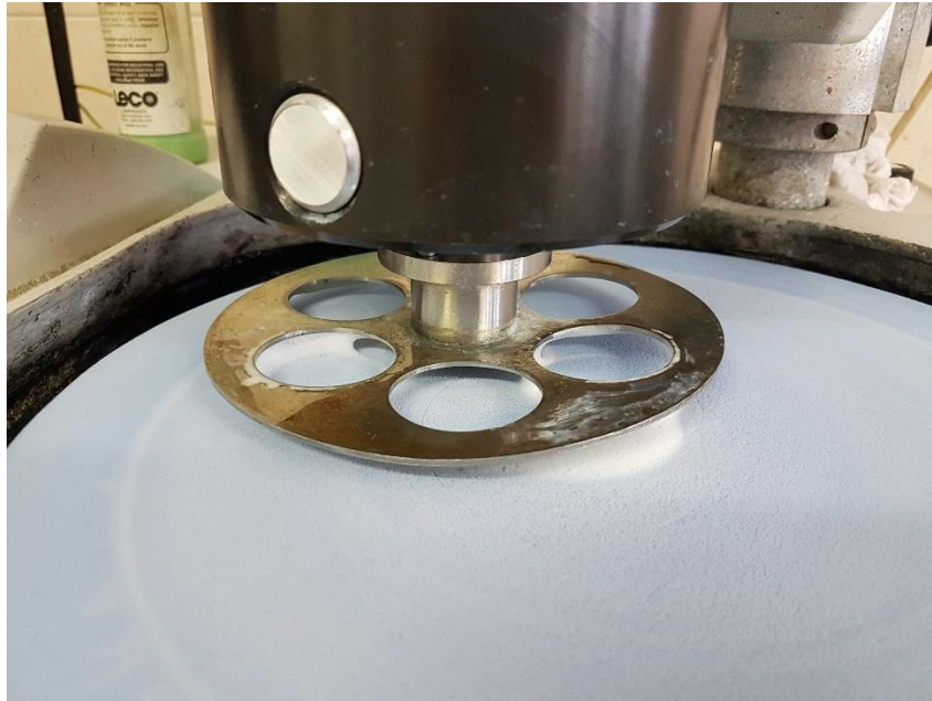
Obrázek 20 Detail na leštící papír s koloidní silikou a podavačem na vzorky
