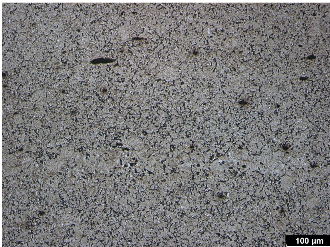
Obrázek 43 Jemnozrnný martenzit na vykované a zakalené čepeli meče
