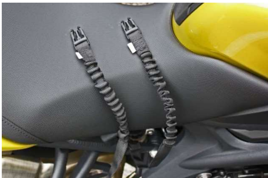
Obrázek 18 Způsob uchycení trhačky k rámu motocyklu, s přezkou
