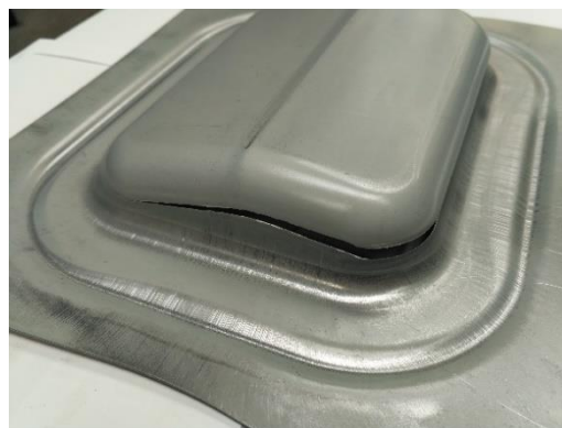
Obr. 22.: Výlisek lisovaný na maximální konstrukční výšku (sendvič)
