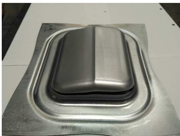
Obr. 23.: Výlisek z oceli lisovaný na maximální konstrukční výšku bez přítomnosti maziva
