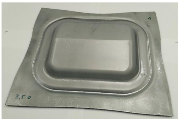
Obr. 21.: Výlisek se zdvihem 5,5 mm (sendvič)
