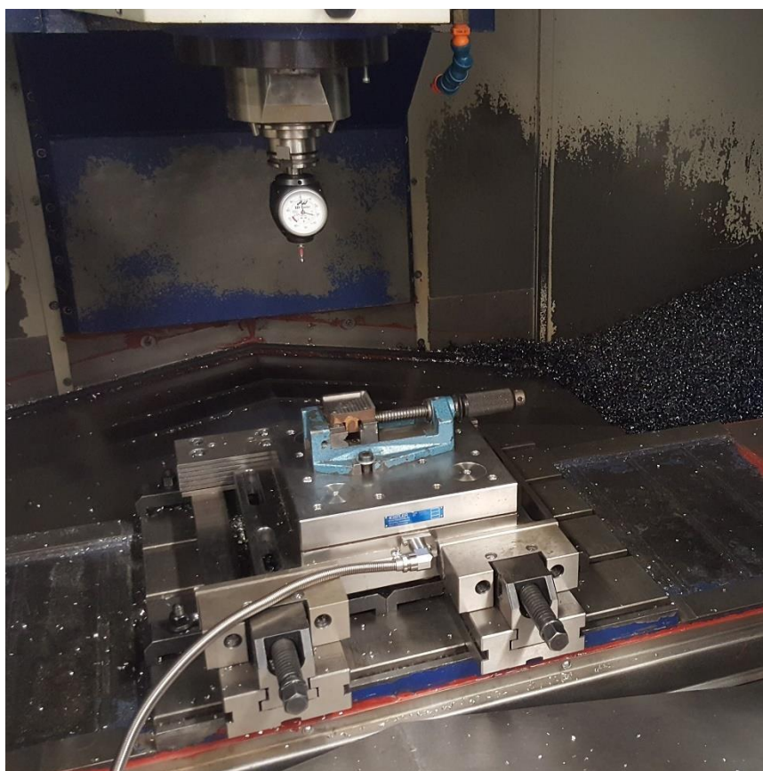
Obrázek 32: Vyrovnání dynamometru v pracovním prostoru stroje
