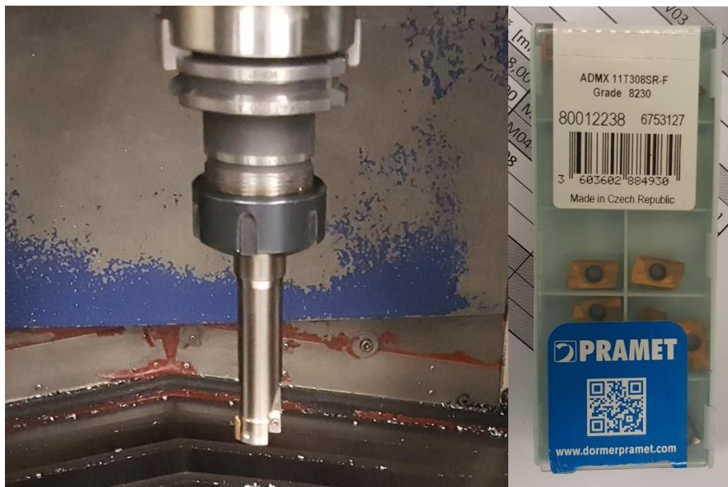
Obrázek 35: Fréza upnutá ve stroji a vyměnitelné břitové destičky
