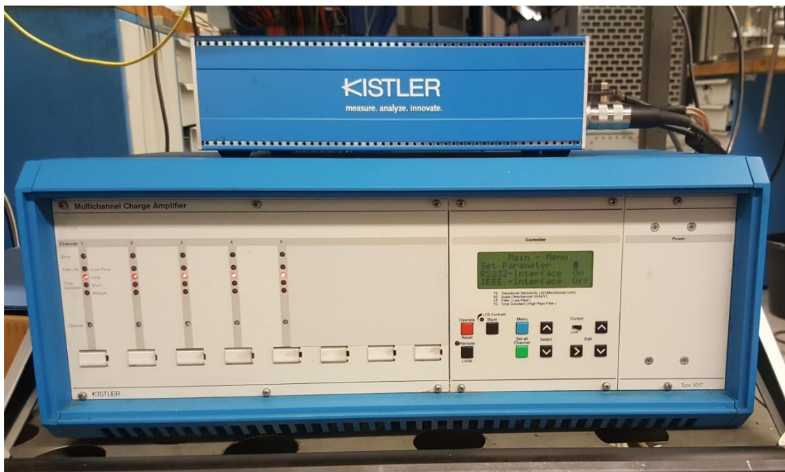
Obrázek 33: Nahoře systém pro získávání dat Kistler Type 5697A, dole multikanálový zesilovač Kistler Type 5017B
