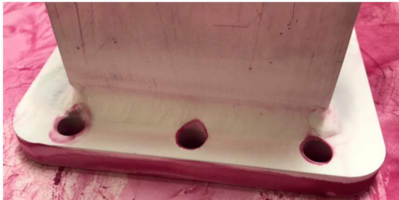
Obr. 42 Nanesení vývojky [zdroj vlastní]
