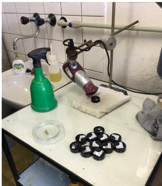
Obr. 51 Sušení naleptaných vzorků [zdroj vlastní]
