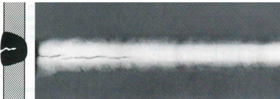
Obr. 22 Trhlina svarového spoje [22]
