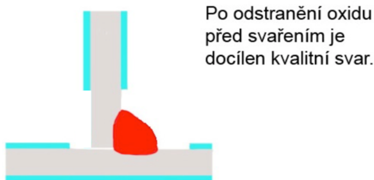
Obr. 18 Odstraněná oxidická vrstva [23]
