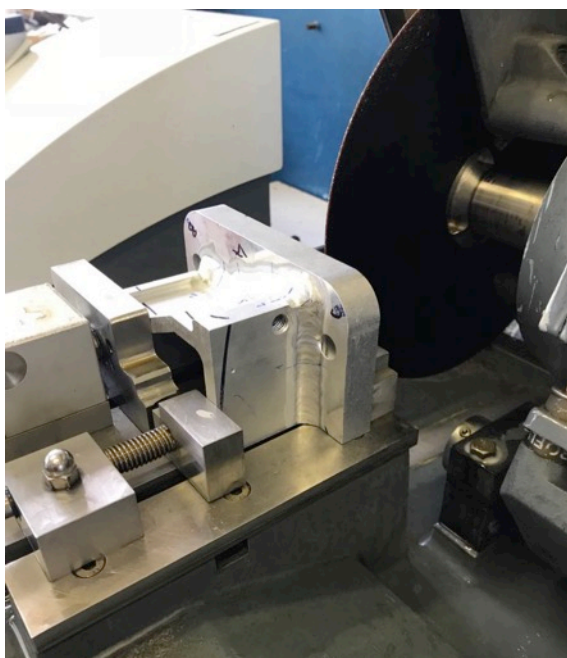
Obr. 47 Řezání vzorku v pile Labotom 3 [zdroj vlastní]
