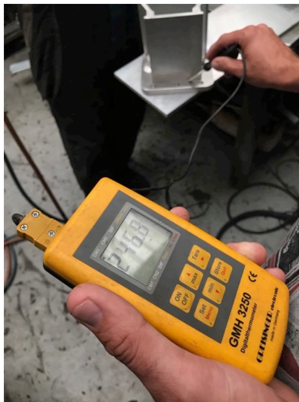
Obr. 38 Měření teploty předehřevu [zdroj vlastní]
