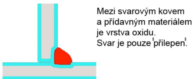
Obr. 17 Neodstraněná oxidická vrstva [23]
