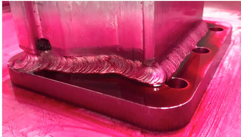
Obr. 41 Nanesení penetrantu [zdroj vlastní]
