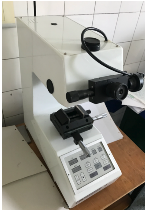
Obr. 27 Tvrdoměr na měření tvrdosti podle Vickerse [zdroj vlastní]
