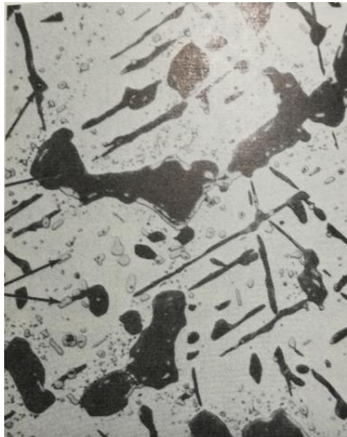
Obr. 4.2: Bloky a desky fáze \sigma (černé části). [16]
