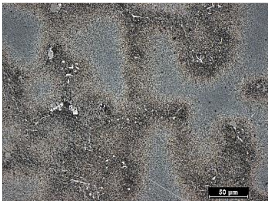
Obr. 7.6: Inconel 713 LC TZ, světelná mikroskopie, zvětšení 200x
