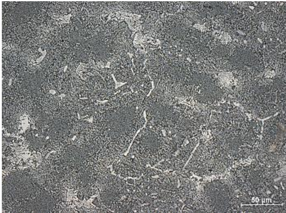
Obr. 7.2: Inconel 713 LC, světelná mikroskopie, zvětšení 200x
