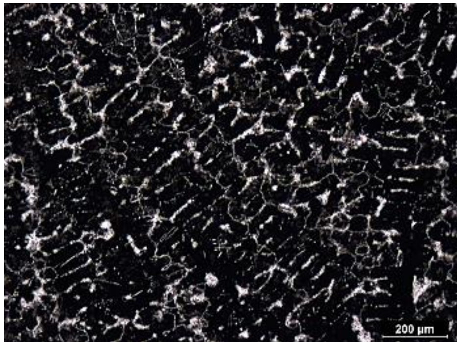
Obr. 7.9: MAR – M 247, světelná mikroskopie, zvětšení 50x
