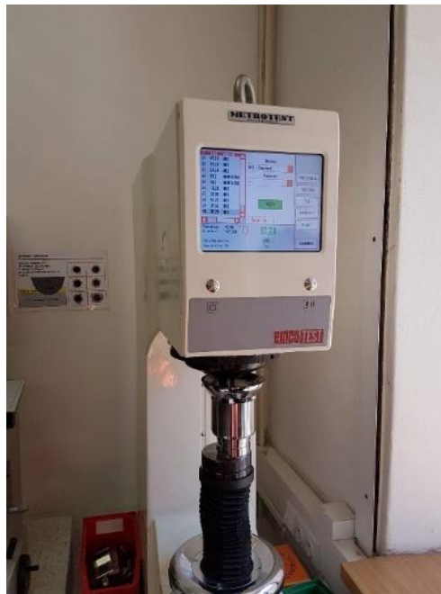
Figure 11: Jádru CTR měřeno na tvrdoměru EMCOTEST M4C 075/750
