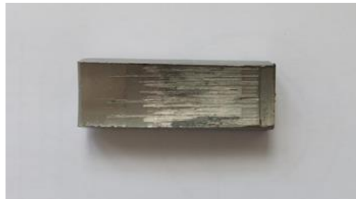
Figure 13 Vzorek č. 1 -Vyříznutá část nástřikové hlavy i s abrazivním opotřebením
