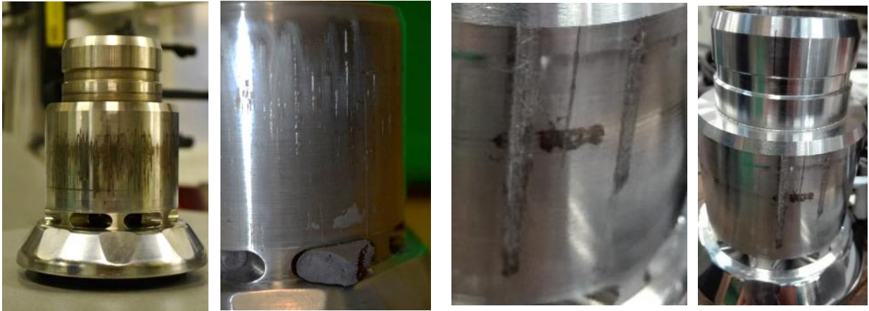
Figure 18 Příklad abrazivního opotřebení součásti - JÁDRO
