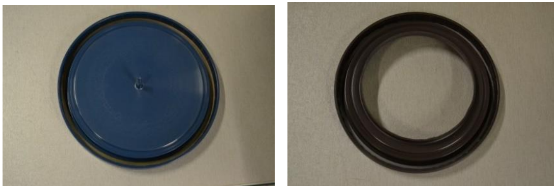
Figure 3: Vlevo simmering vyrobený za použití běžného vstřikování vpravo: simmering vyrobený pomocí CTR
