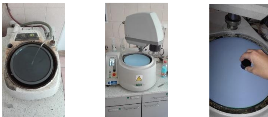
Figure 16: Zleva: Přístroj na broušení, přístroj na leštění a leštění vzorku
