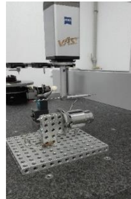
Figure 112 Zleva: Souřadnicový měřicí stroj Carl Zeiss Prismo, jádro CTR připravené k měření
