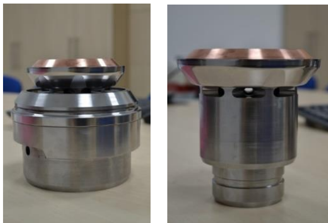
Figure 2 Vlevo: nástřiková hlava a v ní vložené jádro (rozdělovač) vpravo: samotné jádro - rozdělovač
