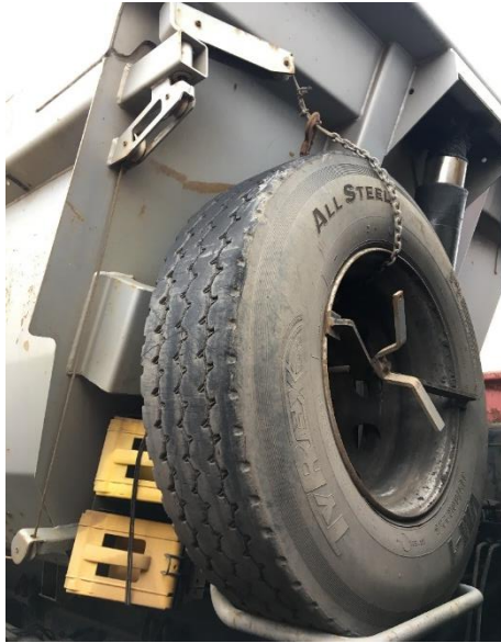
Obr. 14.: Držák kola na korbě
