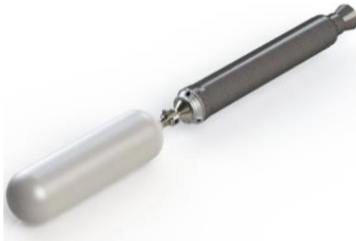
Obrázek 14: Konstrukce hybridu pro pomocnou raketu UAV. Převzato z [18]
