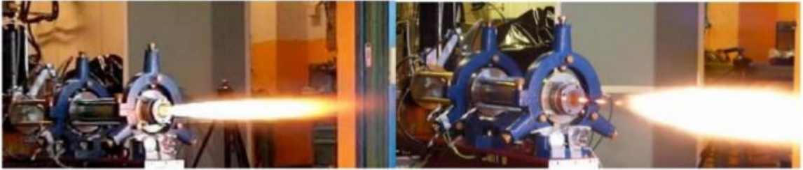
Obrázek 13: Porovnání klasického hybridu s Hybridem vybaveným Vortex systémem. Převzato z [18]
