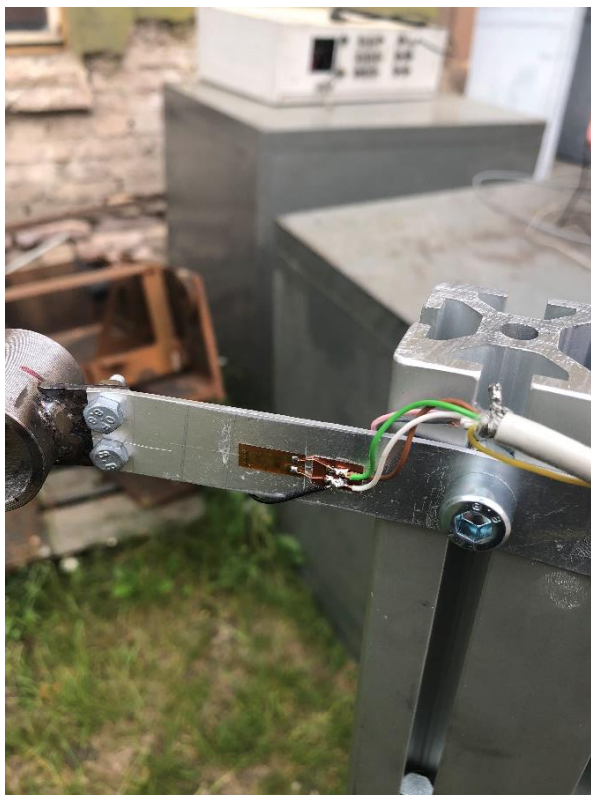
Obrázek 26: Měřicí přípravek s nainstalovanými tenzometry
