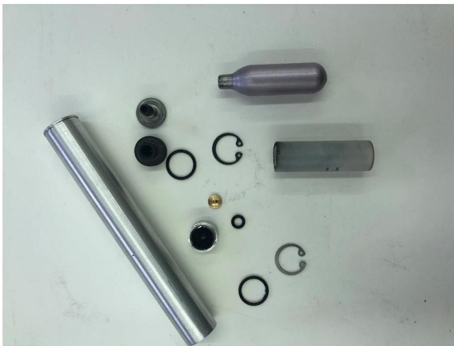
Obrázek 15: Rozložený testovaný hybridní raketový motor.
