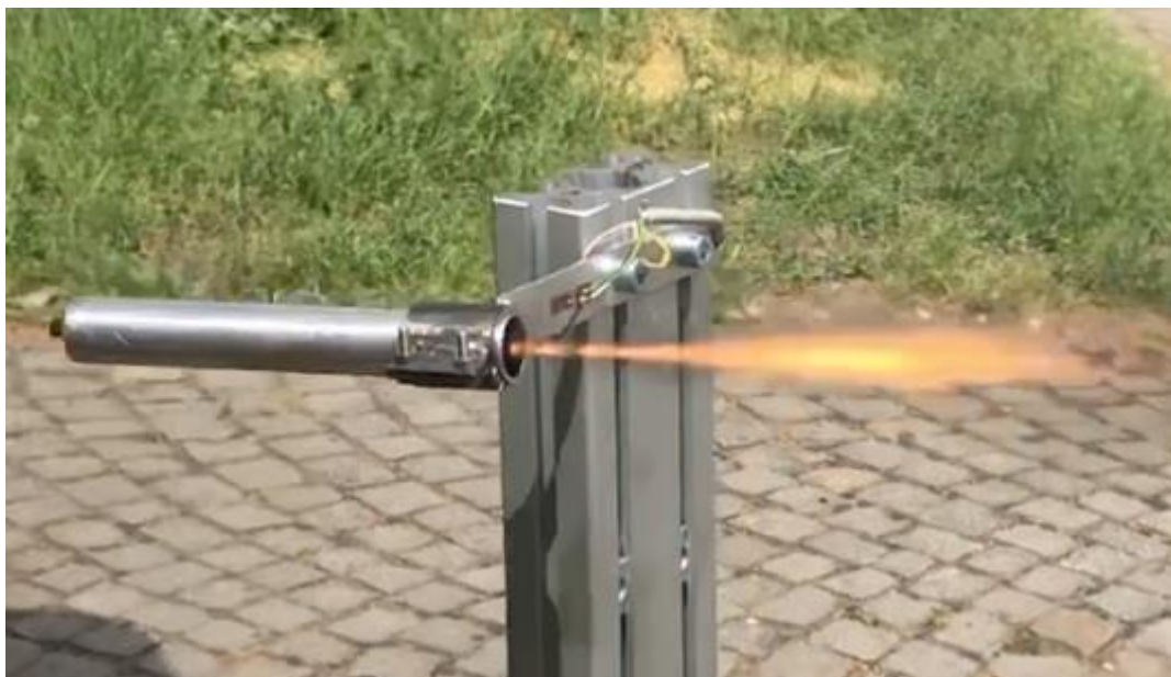
Obrázek 45: Ukázka raketového motoru při zážehu zrna z materiálu PVC
