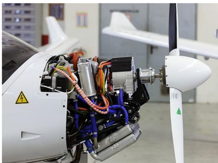
Obrázek 3 - Detail hybridního motoru letadla DA36 E-Star 2 [4]
