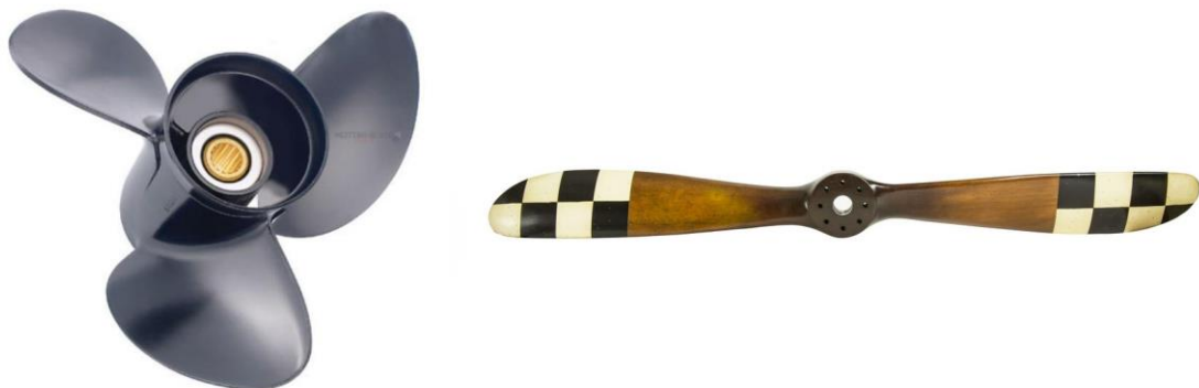
Obrázek 18 - Typický lodní šroub [22] (vlevo) a typická vrtule [23] (vpravo)
