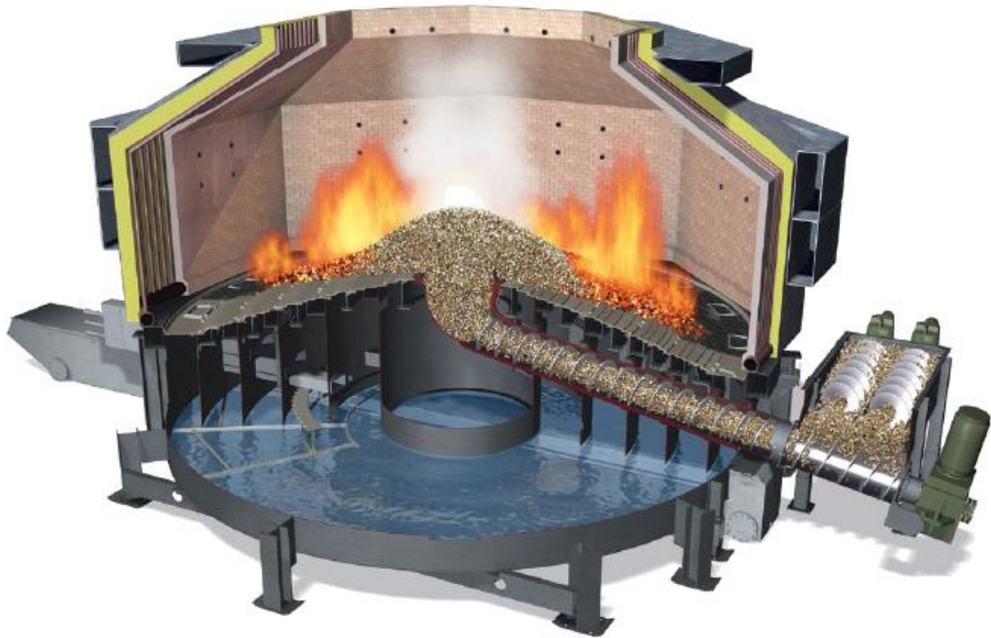
Obrázek č. 13: Spalování dřevní štěpky ve spalovacím zařízení Biopower s podsuvným roštem [17]
