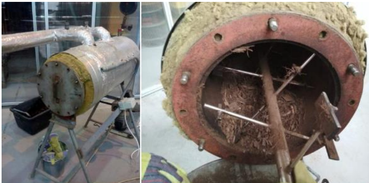
Obrázek č. 22: Vnitřní prostor kampaňové sušky s míchacím zařízením a sušeným materiálem.
