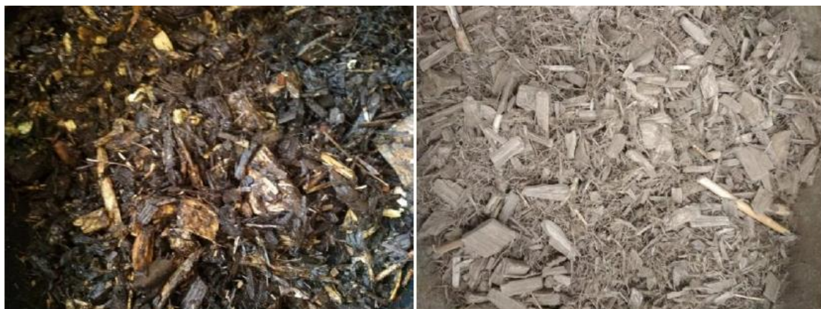
Obrázek č. 15: Vlevo smrková dřevní štěpka v původním stavu a napravo po 3 hodinách sušení.
