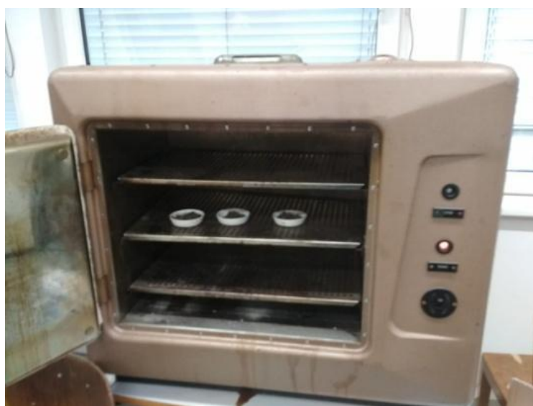
Obrázek č. 21: Speciální elektrická suška se vzorky z laboratoří FS ČVUT na Julisce.
