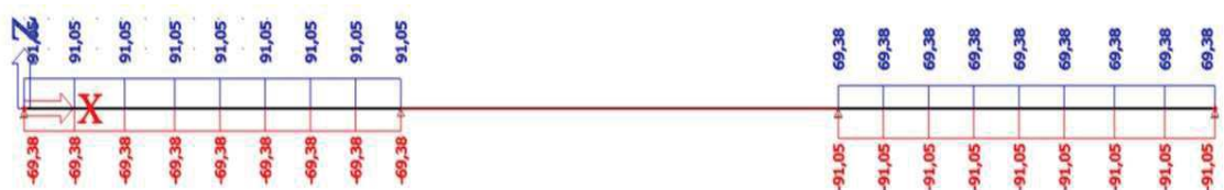
Obr. 49 Obálka posouvajících sil V_z od zatížení teplotou
