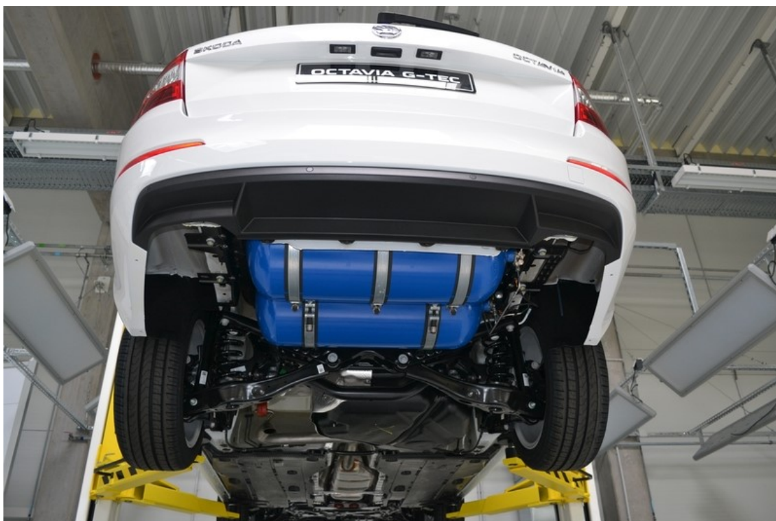
Obr. 4 - Pohled na zadní část vozu Škoda Octavia G-Tec a na jeho dvě ocelové tlakové nádrže, které dohromady pojmu až 15 kg CNG. [13]
