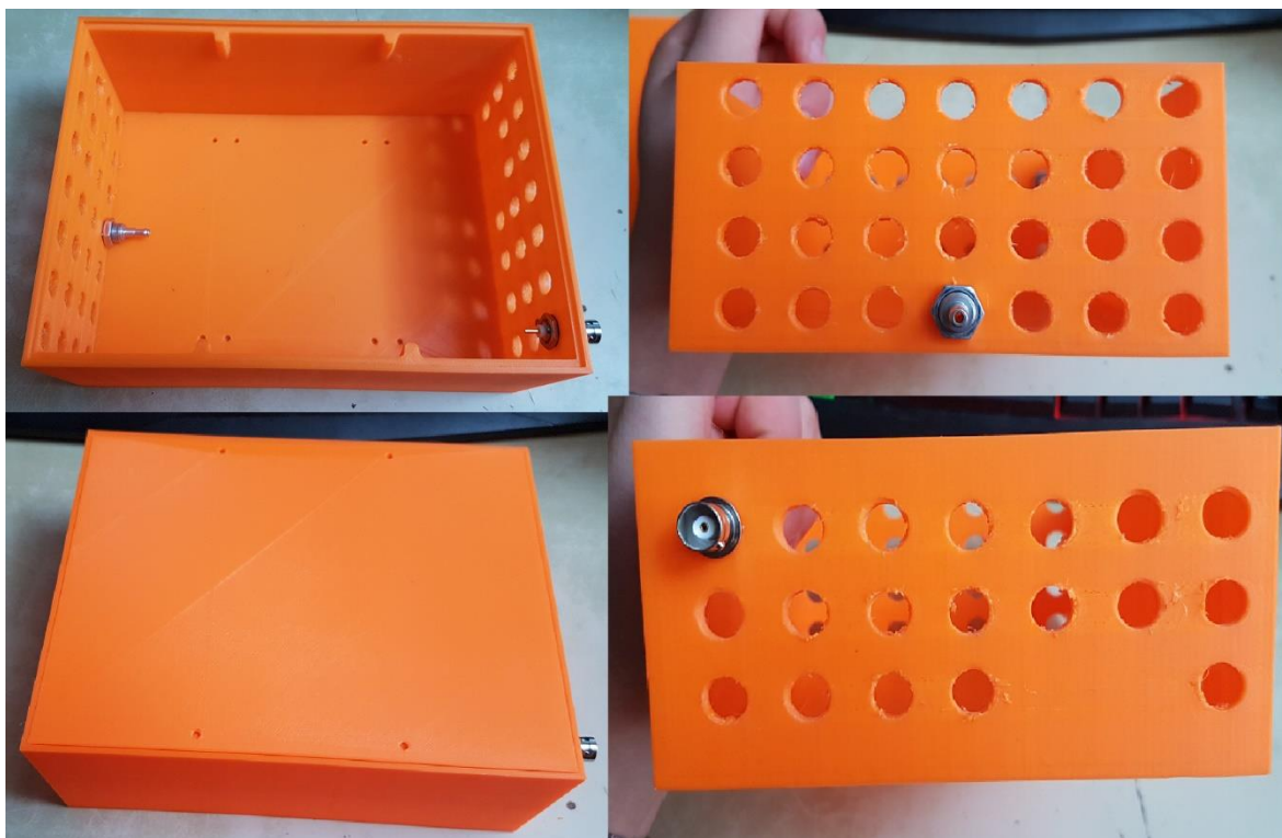
Obrázek 36 – Vytištěná neosazená krabička (průchodka a BNC konektor pro ilustraci umístění)
