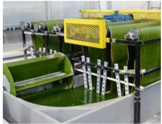
Obr. 7 – Rotujúci biofilmový reaktor na Iowskej štátnej univerzite (USA) [9]
