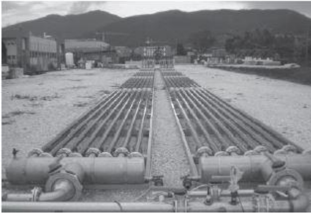
Obr. 6 – Rozvetvujúci sa horizontálny trubkový fotobioreaktor [7]
