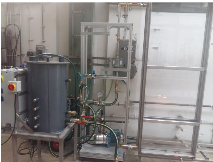
Obr. 45 – Nový systém po inštalácii; v ľavej časti retenčná nádoba, vpravo nový fotobioreaktor.
