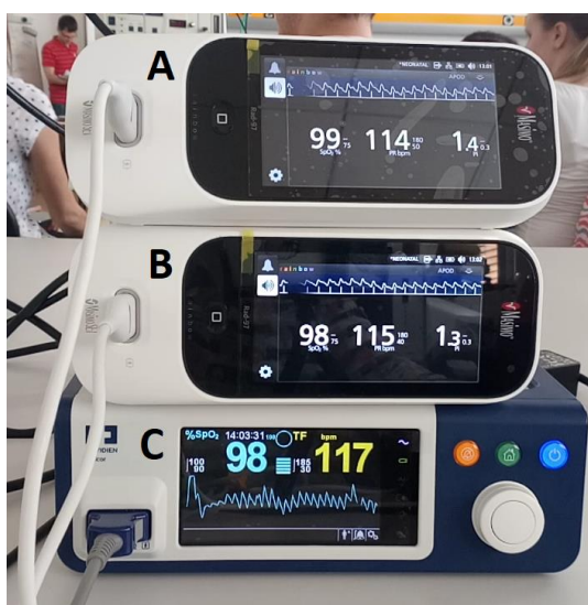
Obr. 3.2: Použité pulzní oxymetry: A) Masimo referenční, B) Masimo měřící, C) Nellcor měřící
