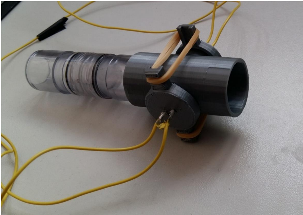
Obr. 2.20. Zrealizovaný model soustavy pro začlenění ultrazvukových měničů do okruhu pacienta
