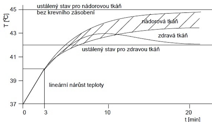
Obr. 1.6: Průběh teploty v nádorové a zdravé tkáni při totožných podmínkách ohřevu [1]
