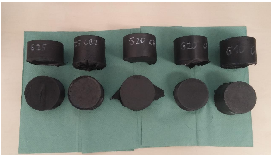
Obrázek 3.1: Ukázka některých připravených vzorků suchých fantomů tkání lidské hlavy
