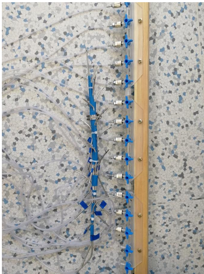
Obrázek č. 2.5: Sonda pro záznam distribuce CO_2 v modelu.
