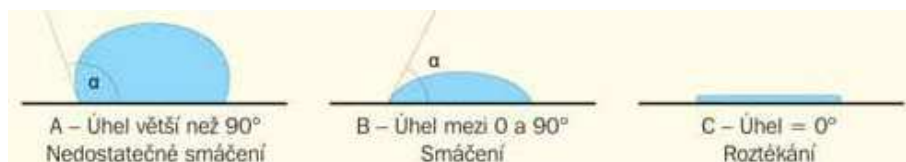
Obr. 17 - Úhel smáčení kapky [15]
