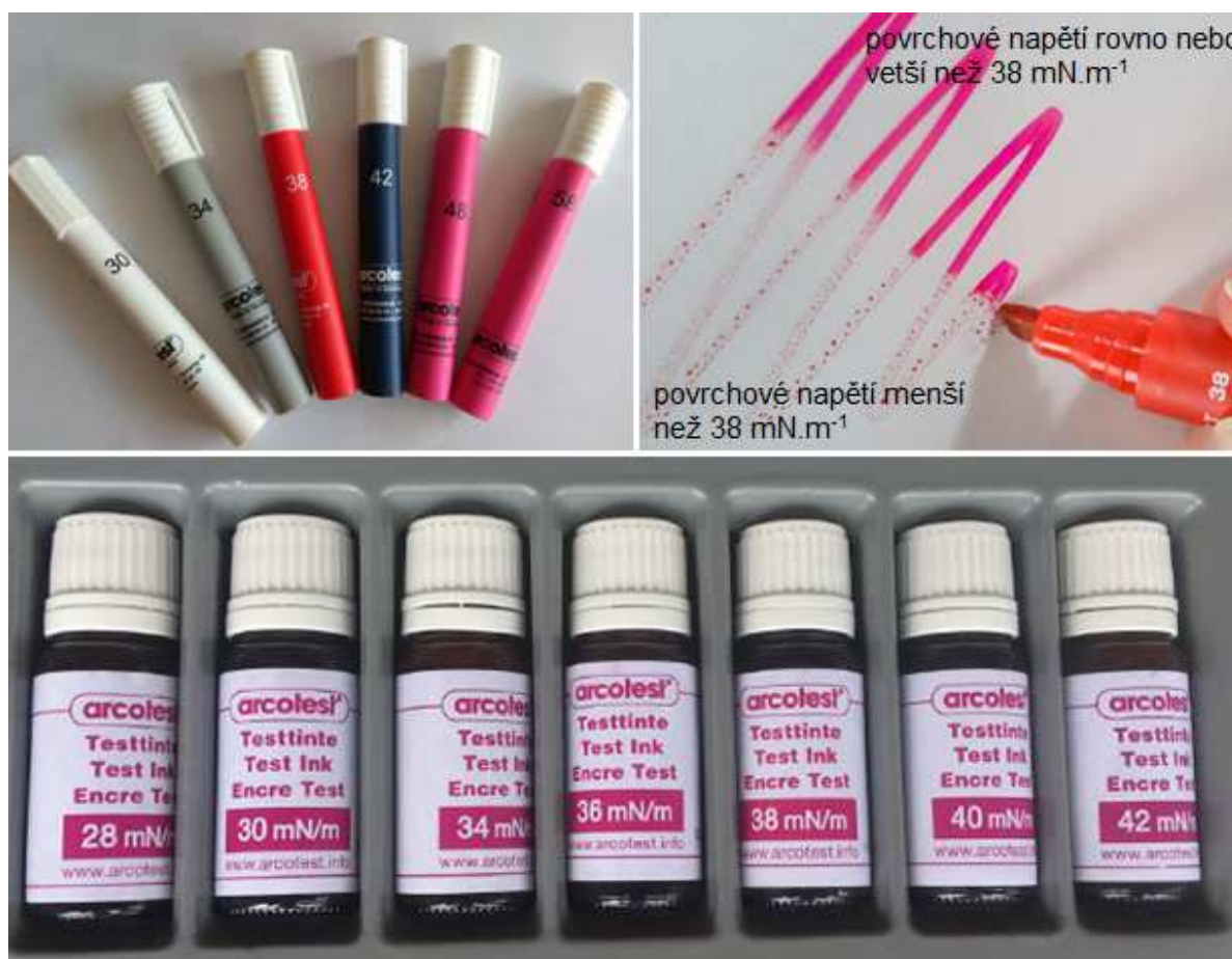
Obr. 16 – Vlevo nahoře fixy Arcotest. Vpravo nahoře použití fixu. Dole inkousty Arcotest [9].
