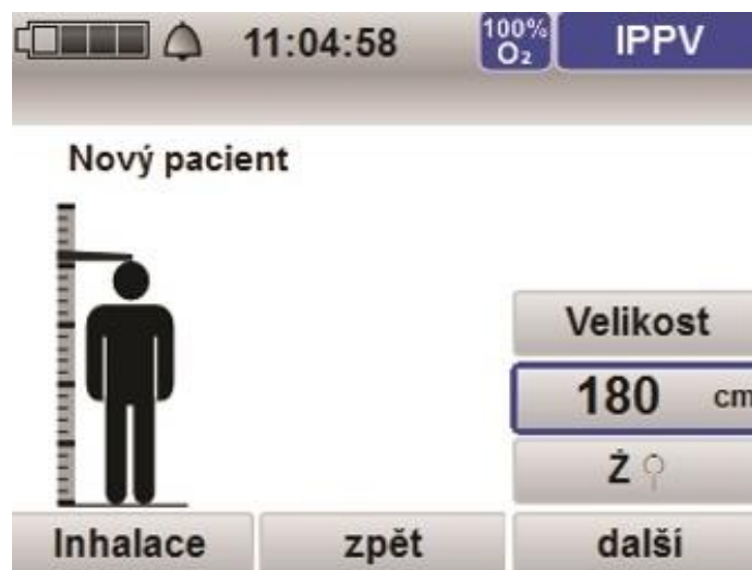
Obrázek 48 Nastavení ventilátoru pro nového pacienta [29]
