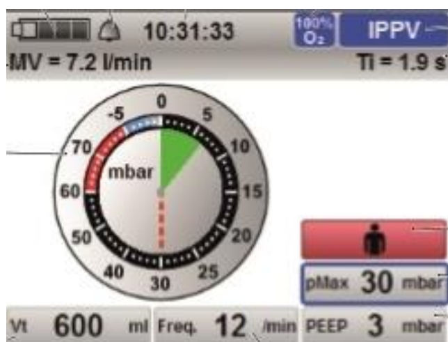
Obrázek 47 Automatické nastavení parametrů ventilace po výběru možnosti „Naléhavý případ – dospělý“ [29]
