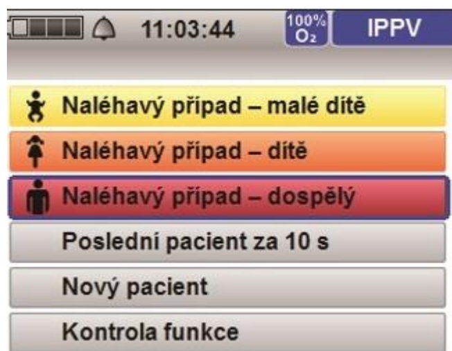
Obrázek 46 Startovací menu po zapnutí ventilátoru [29]
