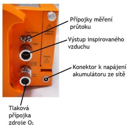
Obrázek 57 Oxylog 3000 a stručný popis jeho ovládacích prvků [37]
