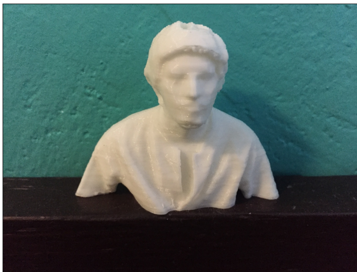
Obr. 2.5: Ukážka spracovania skenu štrukturovaným svetlo pre potreby 3D tlače
