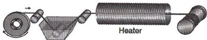
Obrázek 8: Schéma přípravy tenkých vrstev technologií sol-gel [7]
