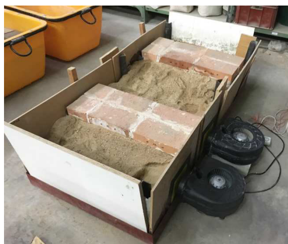
Obr. 48 Ventilátory zajišťující proudění vzduchu v dutinách
