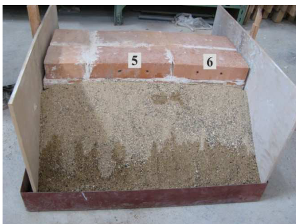
Obr. 36 Laboratorní model s označením měřících bodů – ze strany zeminy
