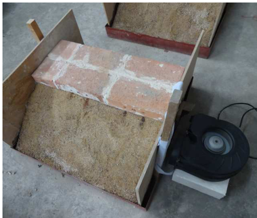
Obr. 38 Ventilátor zajišťující proudění vzduchu v dutině (přes tkaninu a se sníženým výkonem ventilátoru)
