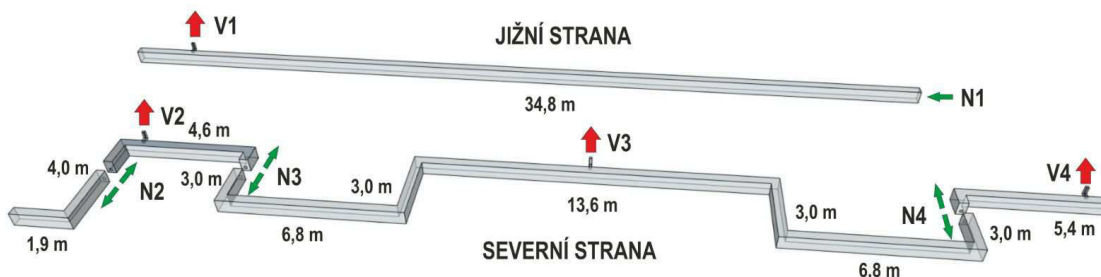
Obr. 9 Schéma provětrávané dutiny s nasávacími a výdechovými otvory
