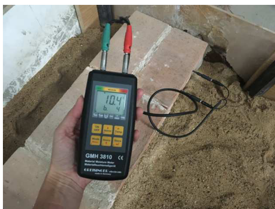
Obr. 50 Měření vlhkosti odporovým vlhkoměrem
