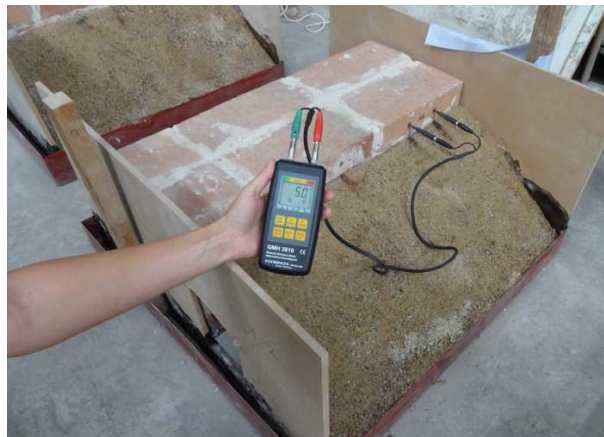
Obr. 39 Měření vlhkosti odporovým vlhkoměrem Greisinger GMH 3810
